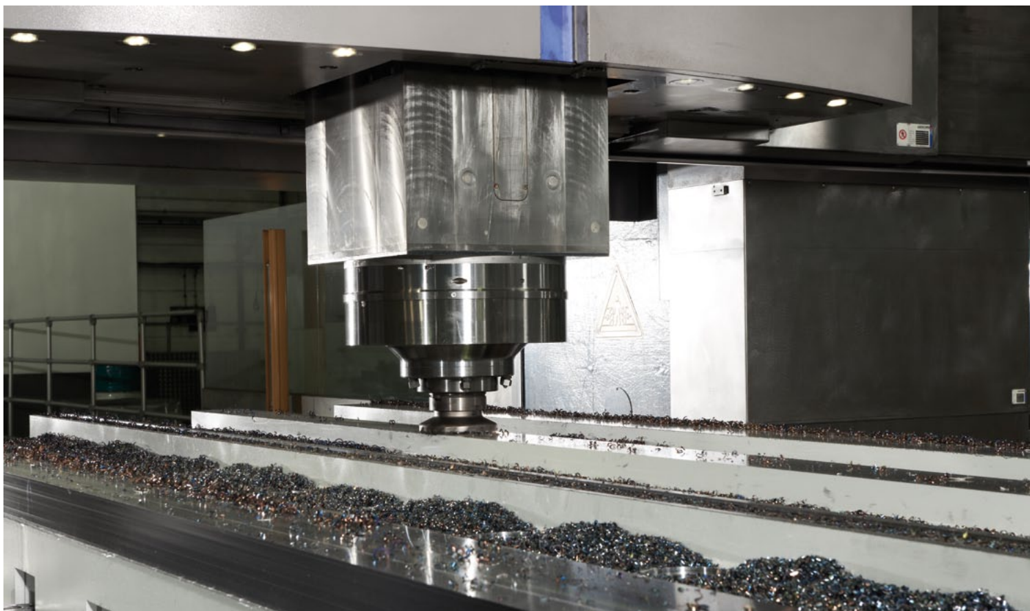
的工厂加工生产床身导轨
